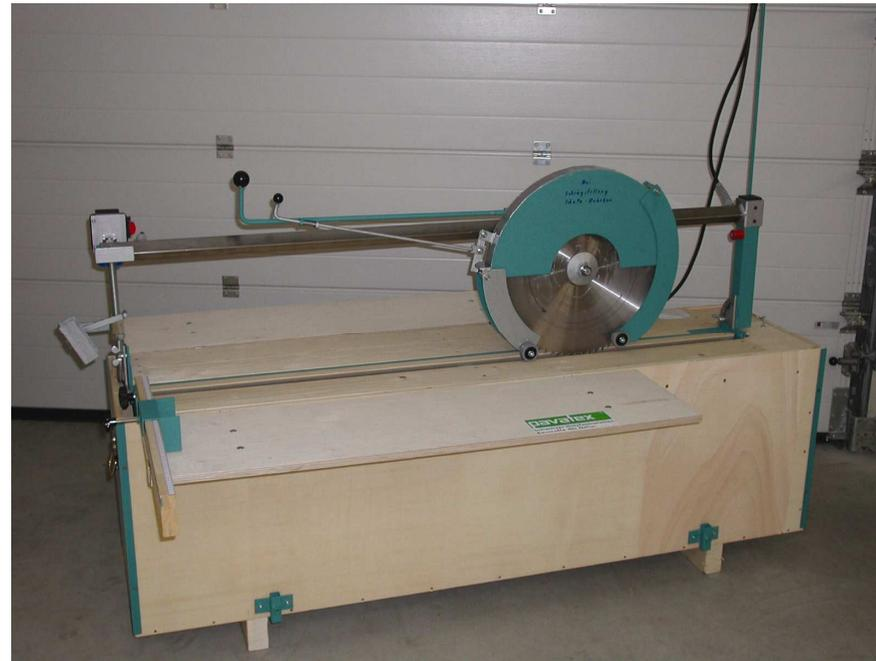
**Il pannello si può tagliare con seghetto alternativo utilizzando le apposite lame fornite da Naturalia Bau oppure con sega circolare con lama specifica (meno polvere, meno surriscaldamento delle lame, tagli più dritti)**
